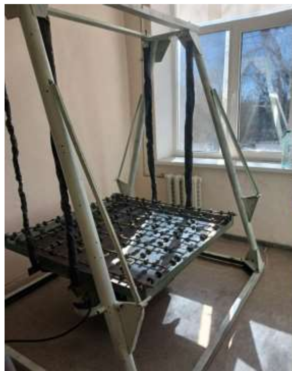
Рис. 1.11- Гойдалка підвісна мікробіологічна з терморегулятором, що встановлена на підприємстві
