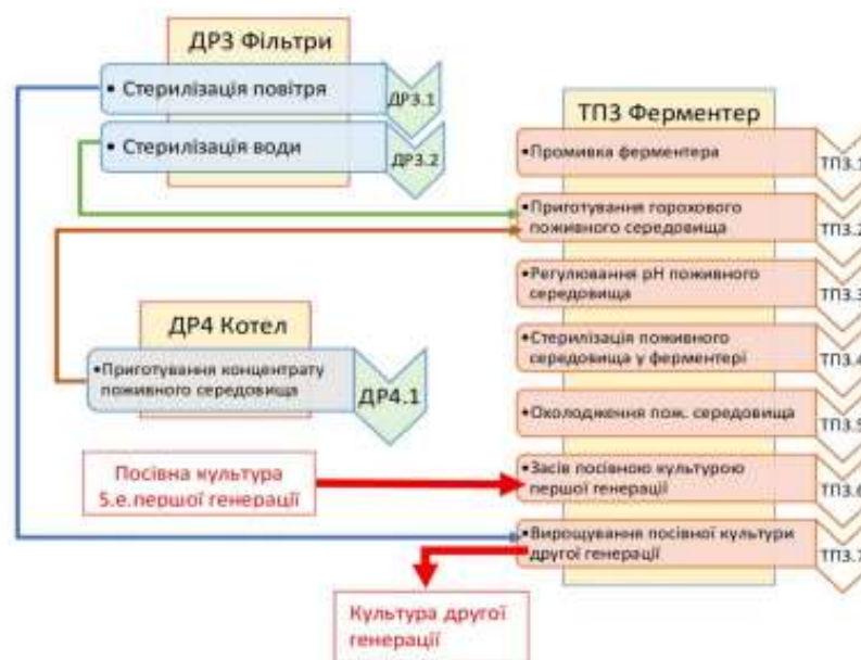
Рис. 1.8 - Схема операційної технології виробництва посівної культури S.e. другої генерації [9].
