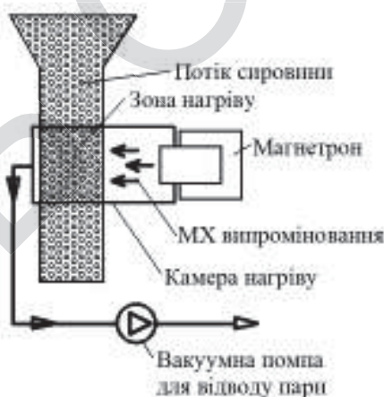
Рис. 2. Принципова схема однопоточного модуля МХ нагріву сипучої сировини.
