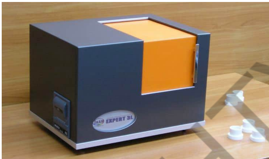
Рисунок 1 – Рентген-флуоресцентний аналізатор EXPERT 3L
