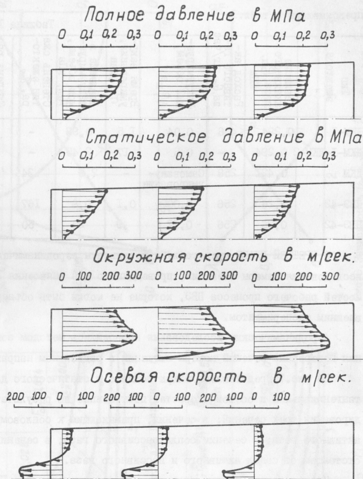
Рис. 7. Эпюры полных и статических давлений, тангенциальных и осевых скоростей в поперечных сечениях камеры смешения противоточного вихревого эжектора ПВЭ-42 при
