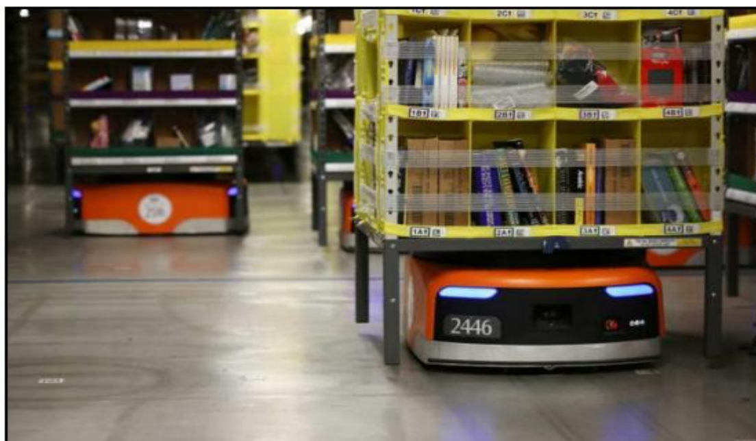
Рис.1.3 - Роботизована система вантажників «Kiva»
