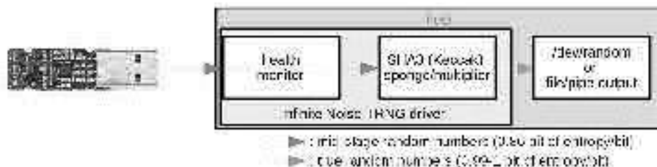
Рисунок 1.14. Апаратний генератор випадкових чисел Infinite Noise TRNG
