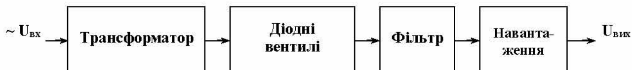
Рисунок 1.1. Структурна схема діодного приладу
