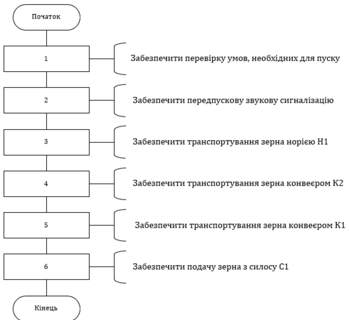
Рис. 4.2 – Блок-схема регламенту на технологічний пуск
