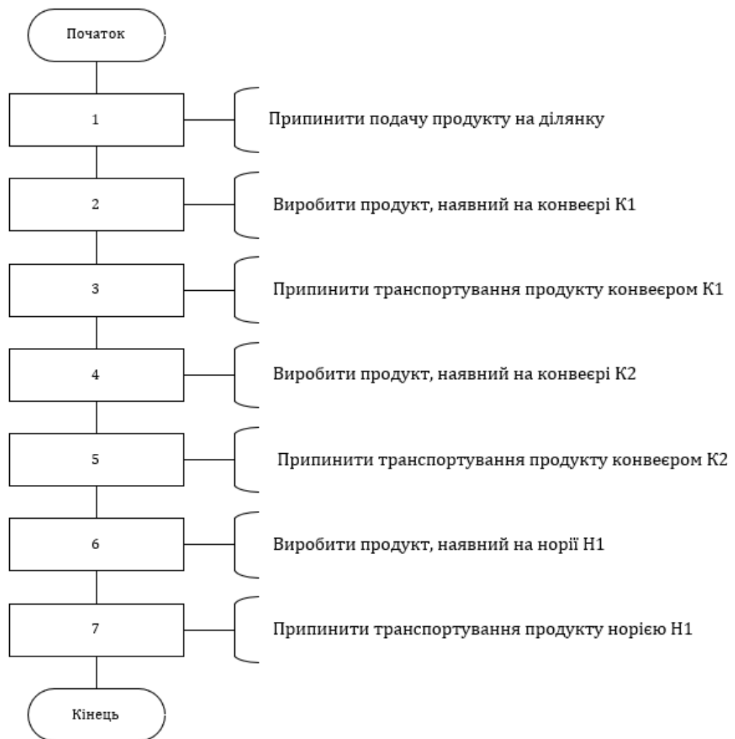
Рис. 4.3 – Блок-схема регламенту на технологічну зупинку.
