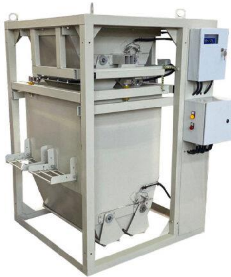
Рис. 1.9 – Приклад бункерних ваг фірми «Сведа, ЛТД», ВБА-640-Е-180
