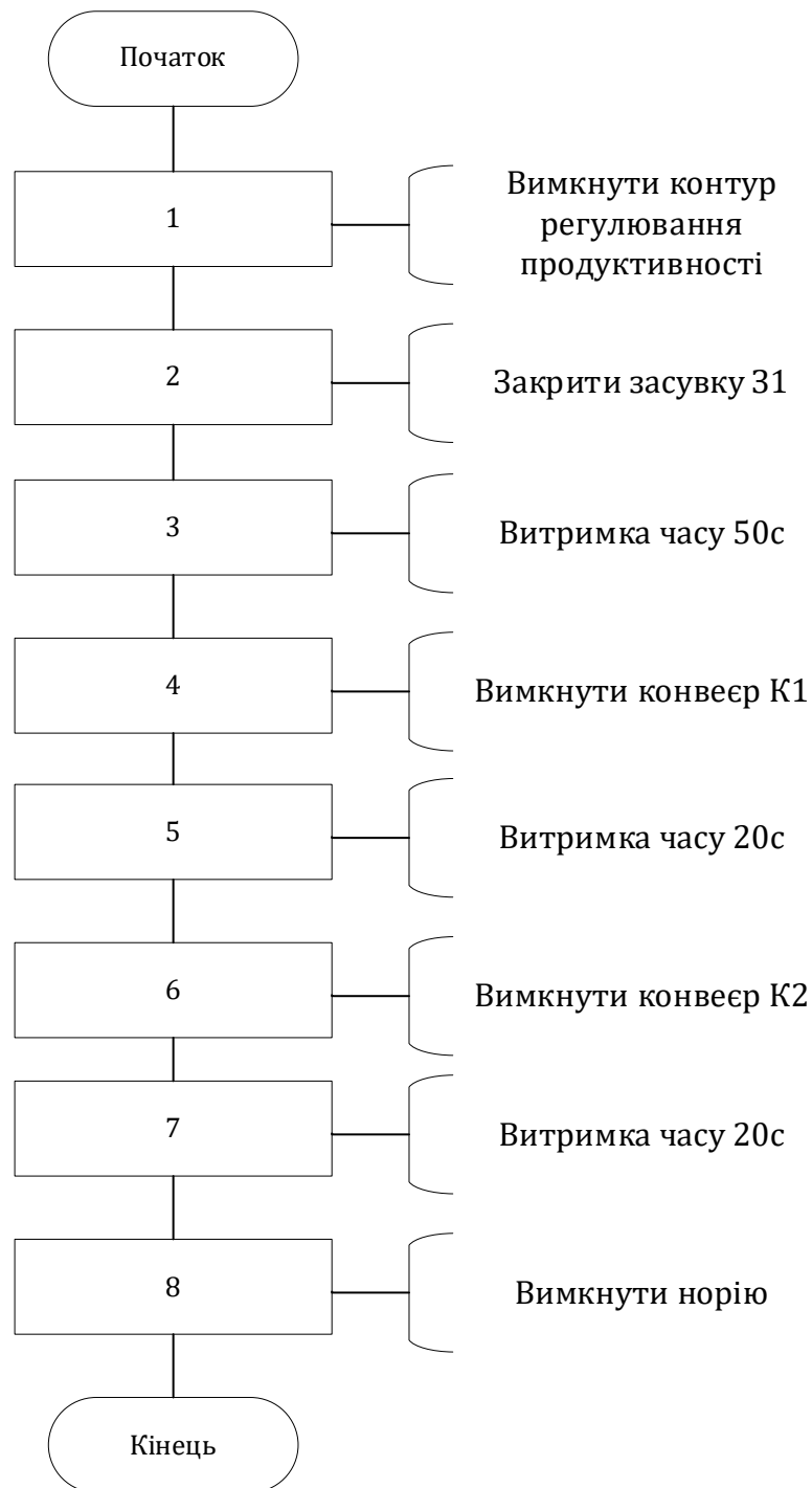
Рис. 4.5 Алгоритм автоматичного керування зупинкою ПТЛ
