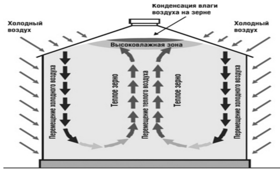
Рис. 1 – Конвекційні потоки та міграція вологи в теплому зерні в холодну погоду
