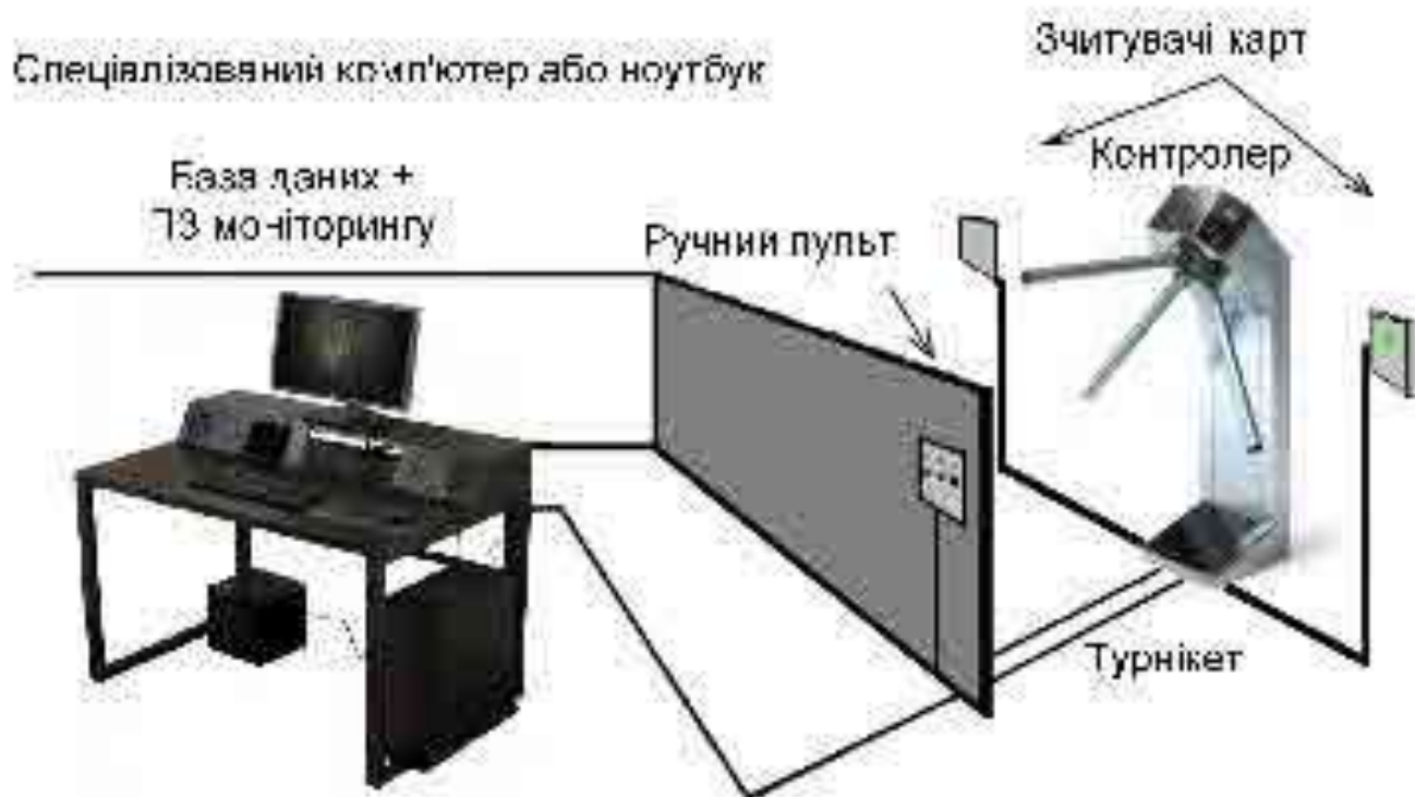
Рисунок 1.3. Загальний вигляд автоматизованої прохідної на об'єкті
