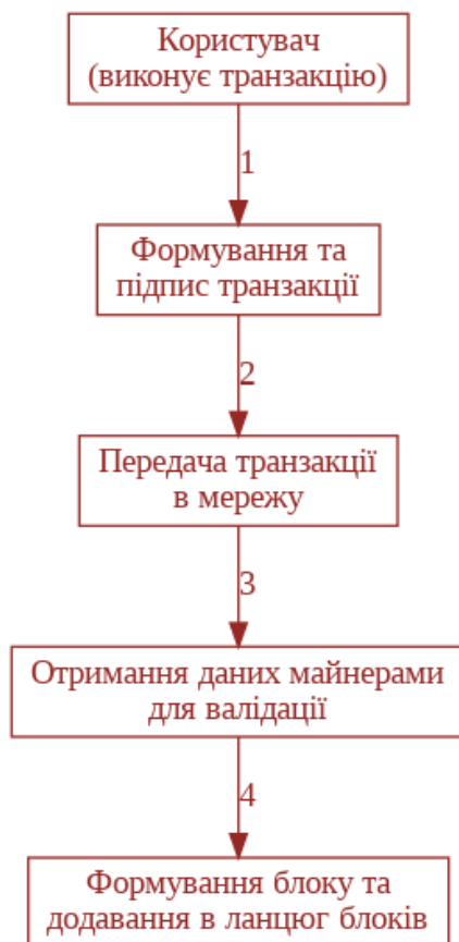
Рисунок 1.2. Процес обробки транзакції у мережі Ethereum
