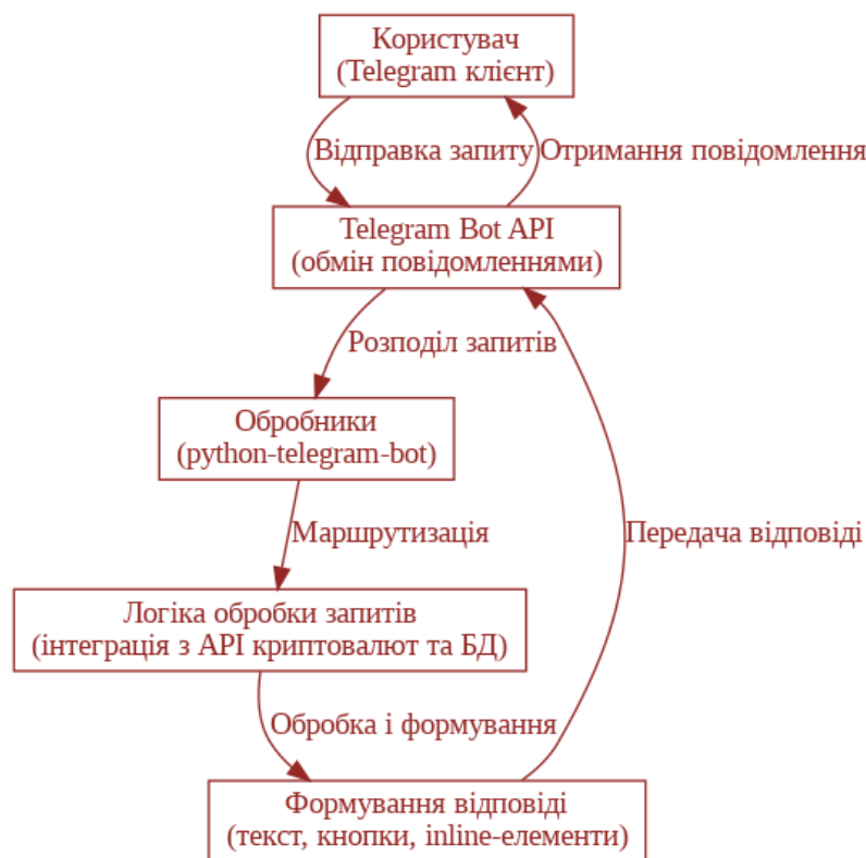
Рисунок 1.7. Схема взаємодії між основними компонентами інтерфейсу
