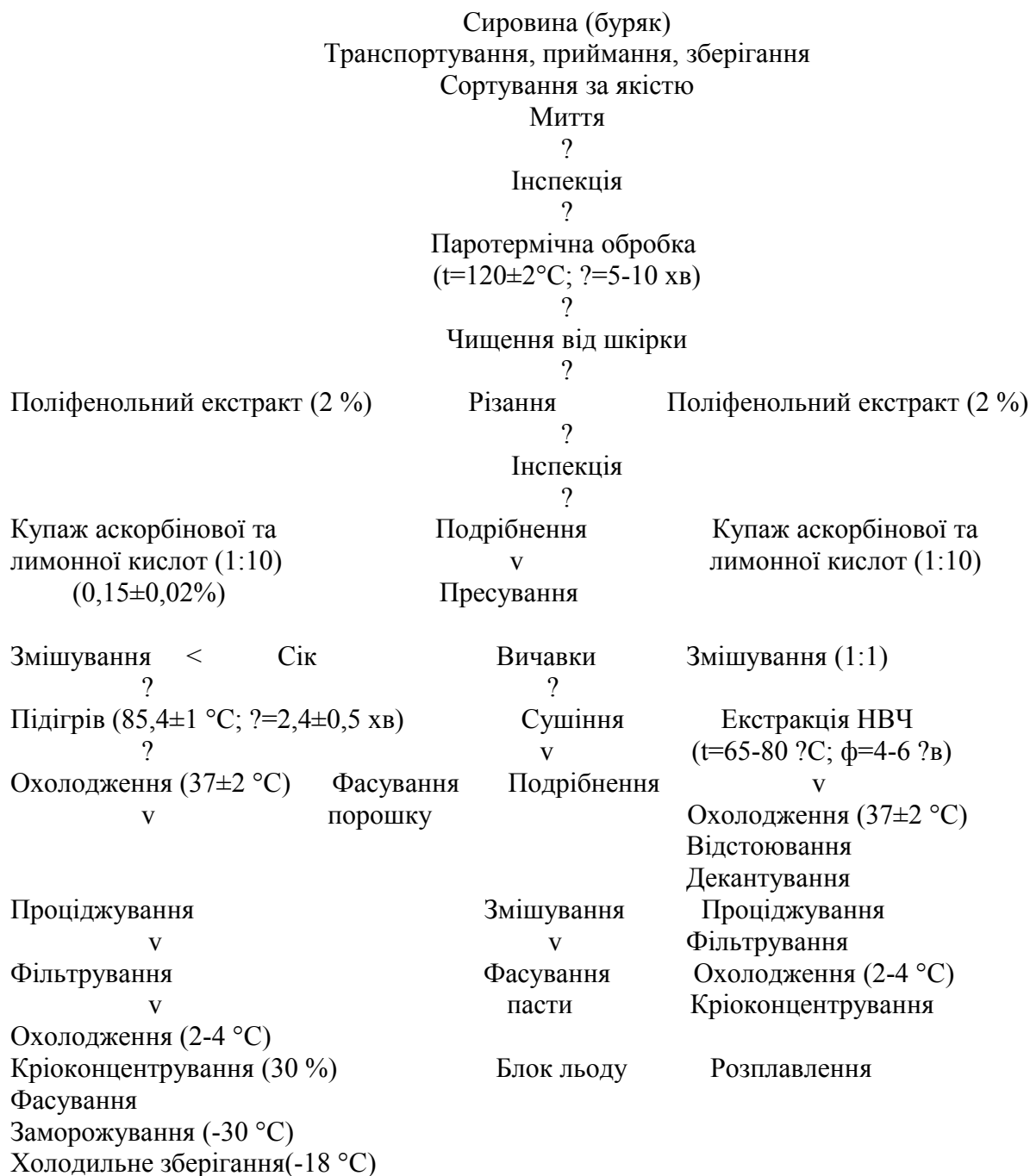
Рис. 7. Технологічна схема виробництва стабілізованого бурякового кріоконцентрату Аналіз різних засобів консервування показав, що тривале зберігання високої якості отриманого концентрату забезпечується швидким заморожуванням при -30\text{ }^{\circ}\text{C} та зберіганням при температурі не вище -18\text{ }^{\circ}\text{C} . Для короткочасного зберігання (до 1 місяця)
