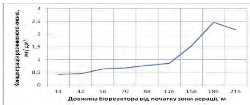
Рисунк 1 – Розподілення концентрація розчиненого кисню по довжині зони аерації біореактора
