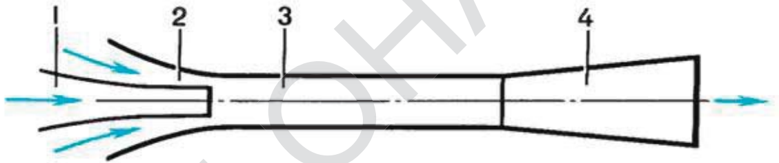
Рис. 3. Ежектор: 1 – потік з низьким тиском; 2 – потік з високим тиском; 3 – звуження; 4 – дифузор
