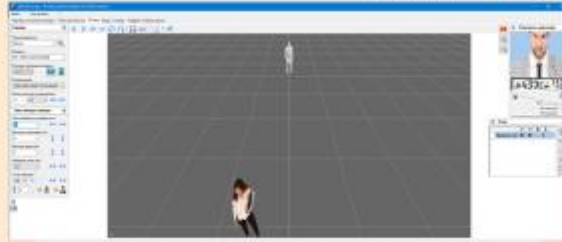
в) Оптимальне зображення: висота встановлення камери - 4 м; відстань від камери - 10м; висота об'єкту спостереження - 2м.
