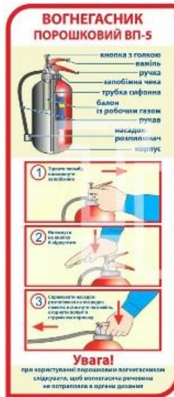
Рисунок 5.6 – Схема порошкового вогнегасника
