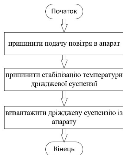
Рис. 4.3 Алгоритм функціонування при зупинці апарату
