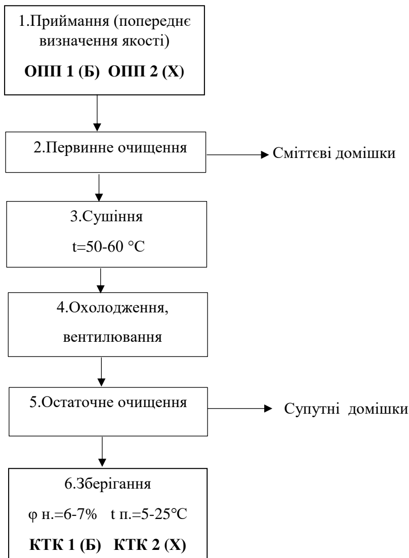
Рис. 2.1. Блок-схема післязбиральної обробки та зберігання насіння соняшнику
