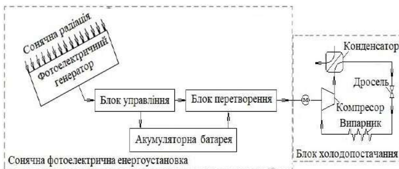
Рис. 2 – Сонячна енергоустановка з ПХМ
