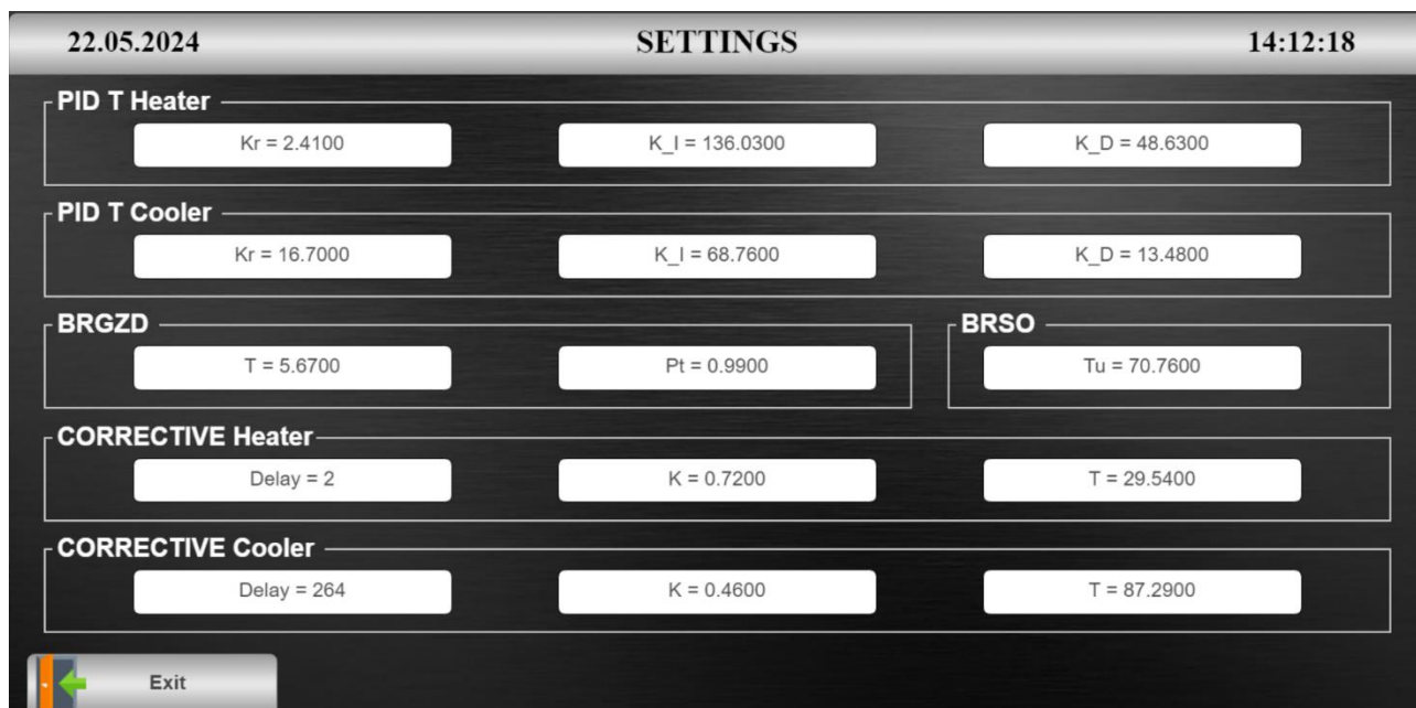
Рисунок 5.23 – Тестування веб-візуалізації вікна, що надає можливість налаштування системи гарантуючого керування процесом гарячого копчення ковбас
