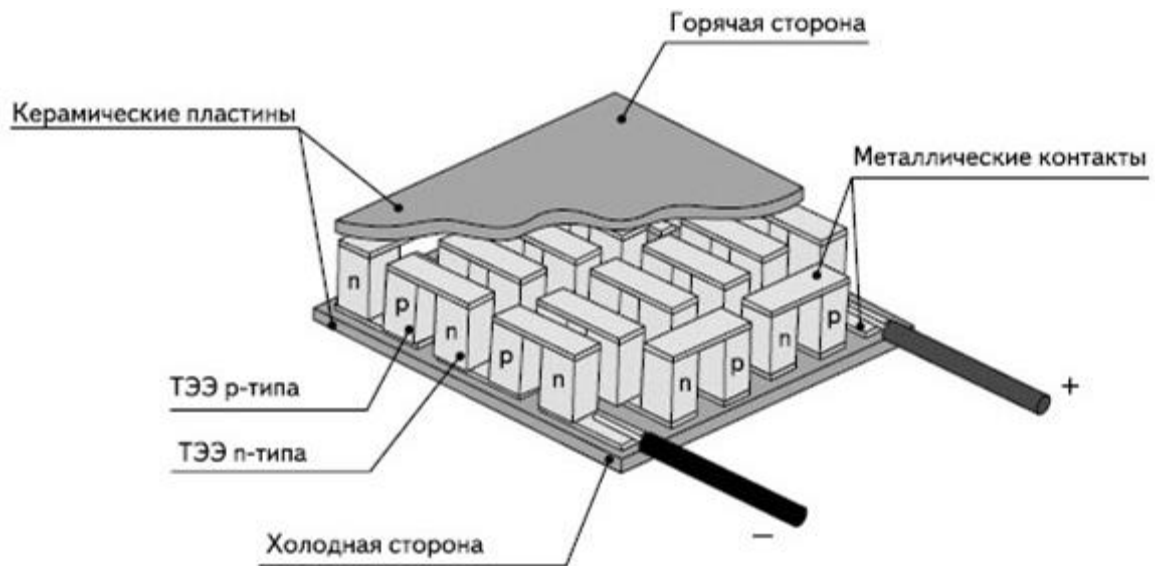
Рисунок 1.7 - Схема дії елемента Пельть'є
