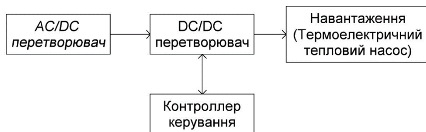
Рисунок 1 - Структурна схема потужного програмованого джерела струму для використання в системах керування термоелектричними тепловими насосами
