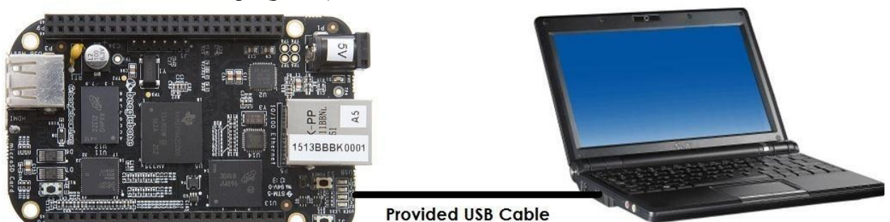
Рисунок 1 – підключення beaglebone black до ПК через USB-кабель
