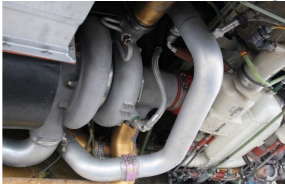
Зовнішній вигляд турбоохолодильної установки самолёту Boeing 737. [68] [124].
