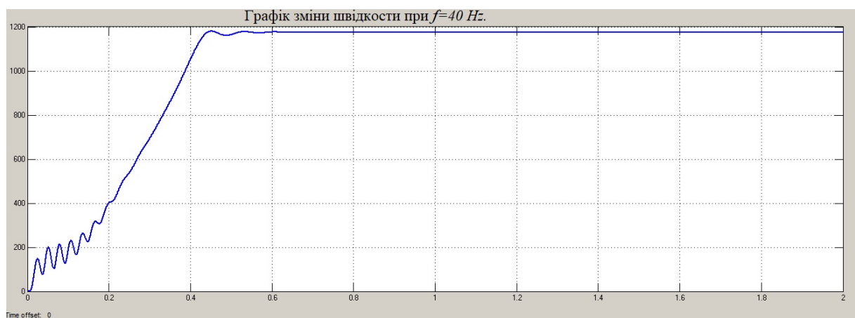
Рис. 3.9 Графік зміни швидкості при використанні частотного перетворювача частотою 40 Гц.
