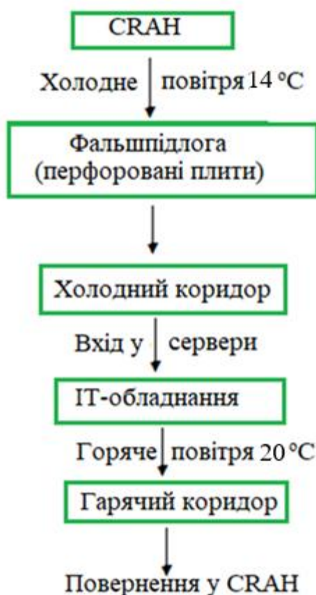
Рис. 12. Схема руху повітря у серверному залі
