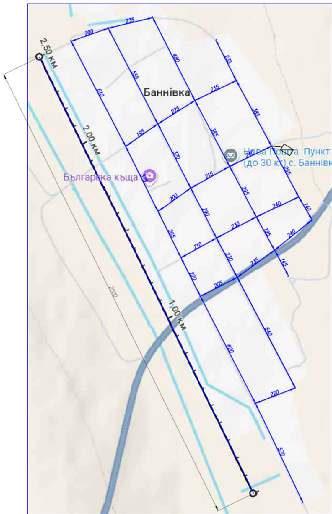
Рисунок 3.1 – План газової мережі в селі Баннівка в масштабі 1:5000 з прив'язкою до карти населеного пункту
