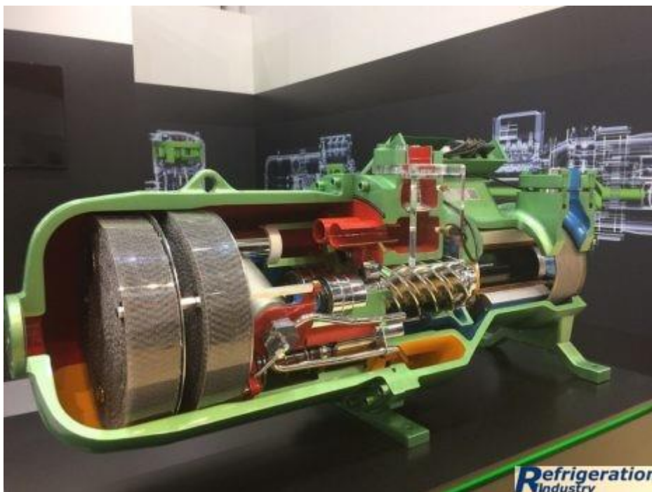
Рис. 1.4. Гвинтовий холодильний компресор
