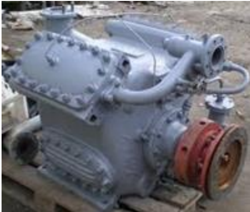
Рис. 1.2. Поршковий сальниковий компресор ПІ 10
