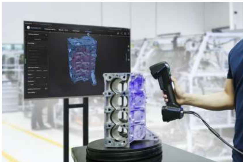
Рис.1.1 – Приклад створення 3D-моделі промислового зразка портативним сканером
