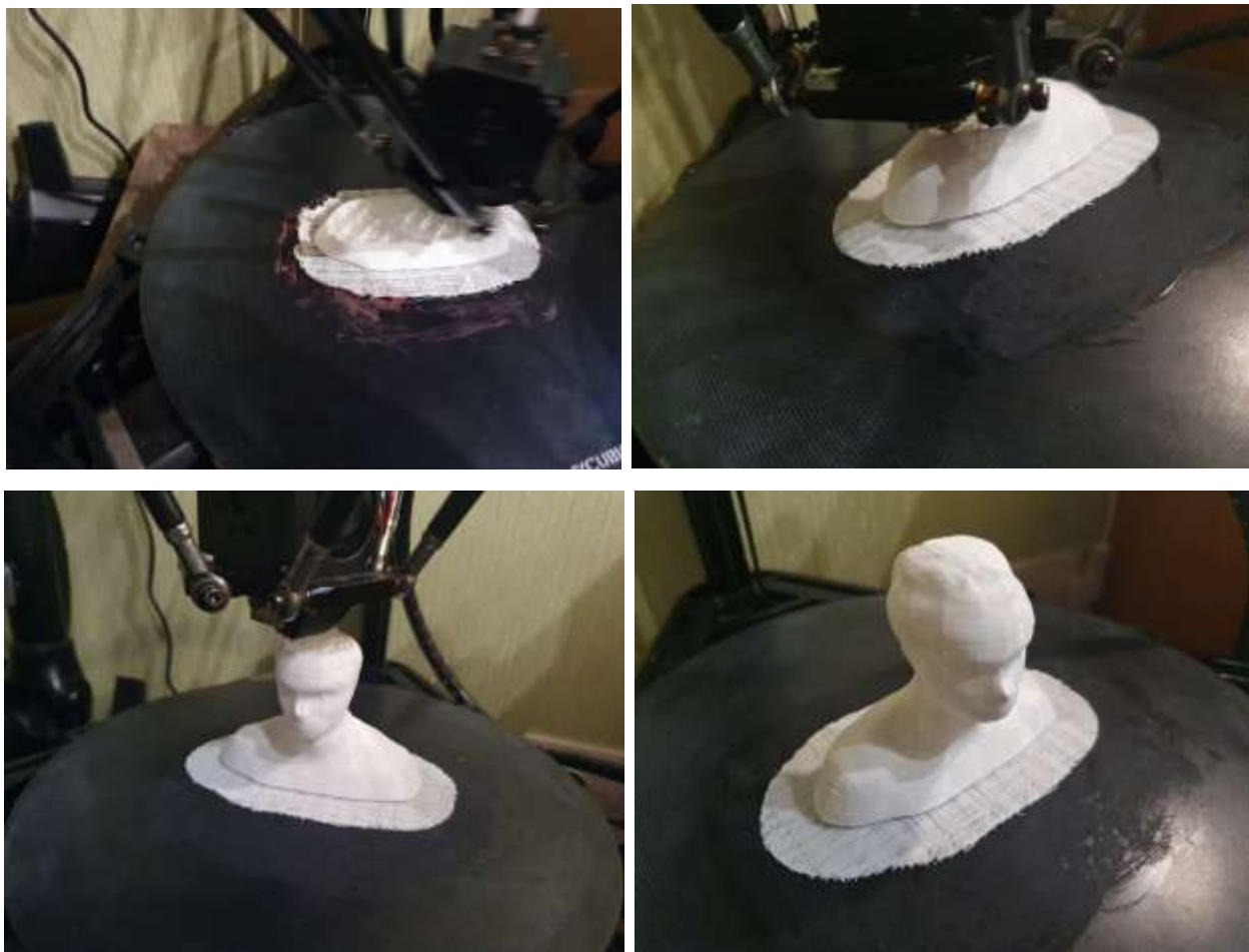
Рис.3.9 – Покроковий друк розробленої моделі на 3D-принтері Anycubic Kossel
