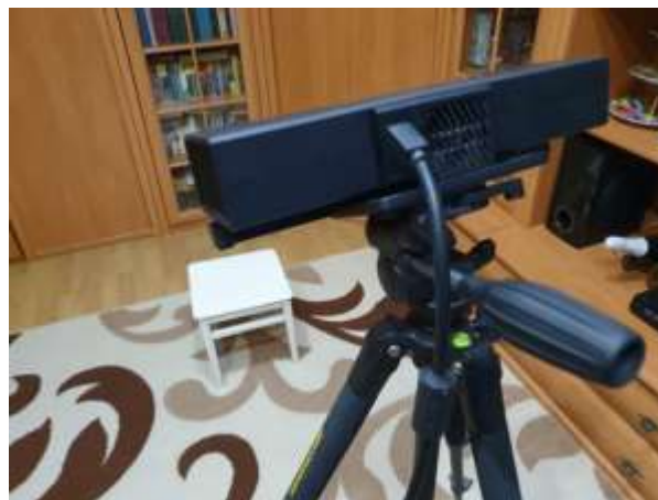
Рис. 3.3 – Жорстке закріплення пристрою Kinect за допомогою штатива
