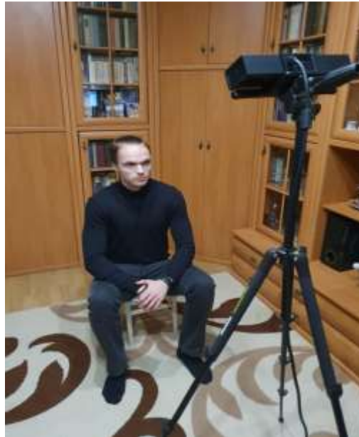
Рис. 3.2 – Розташування об'єкта та пристрою Kinect під час сканування
