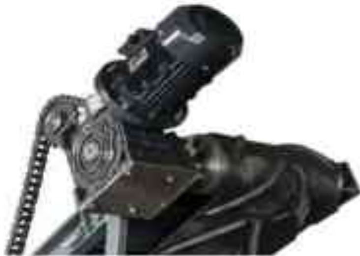
Рис. 16. Привід стрічкового конвеєра з мотор-редуктором: 1 – електродвигун; 2 – муфта пружна; 3 – черв'ячний редуктор; 4 – ланцюгова передача; I – провідний вал редуктора; II - ведений вал редуктора; III - вал приводного барабана
