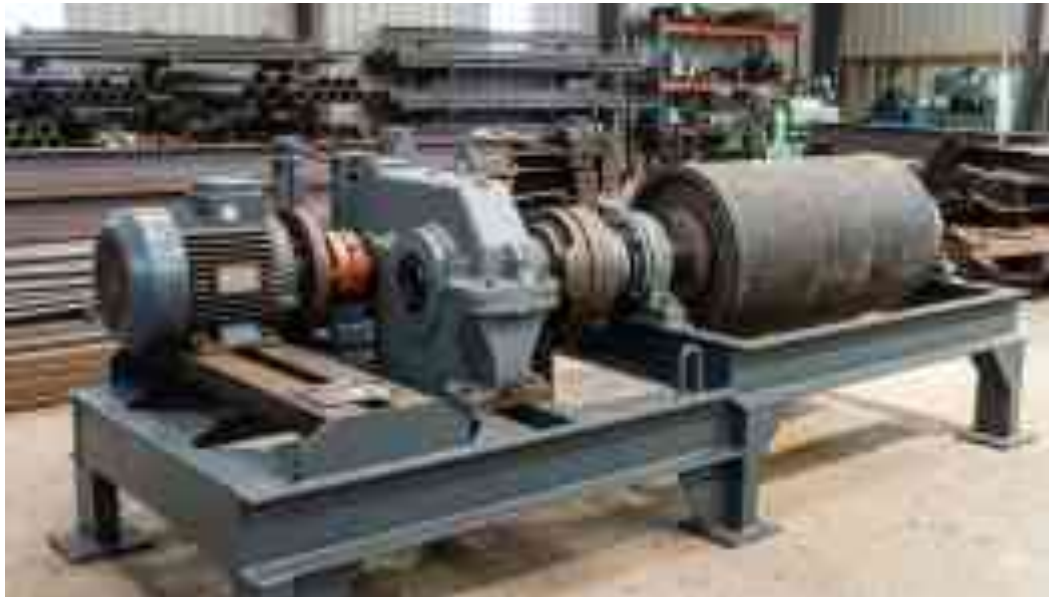
Рис.14. Привідна станція високонавантаженого стрічкового конвеєра
