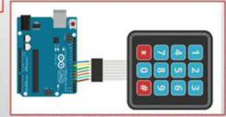
Підключення мембранної клавіатури 4x4 до плати Arduino
