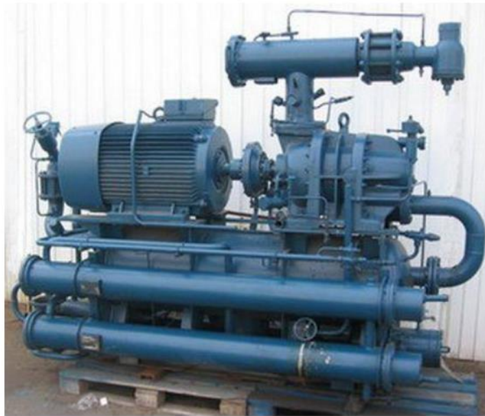
Рисунок 2 Гвинтовий компресорний агрегат з оливовіддільником і водяним охолоджувачем оливи [2]
