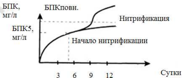
Рис. 2 - Изменение характера потребления кислорода при нитрификации
