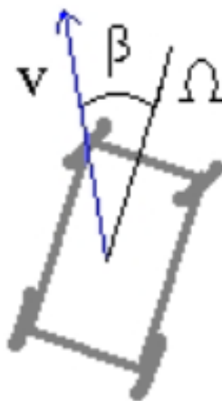
Рис. 2.8 – Схема бокового кута ковзання
