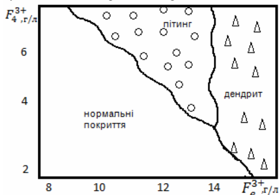
Рис. 3 – Вплив технологічних домішок в електроліті хромування на утворення дефектів покриття. Сульфатно-фторидний електроліт, щільність катодного струму 45 А/дм 2 , температура 57 °С
