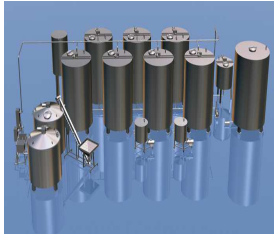
Рис.2 – Линия купажного сиропа для сыпучих продуктов
