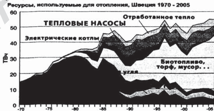
Рис.1 Энергетический баланс системы отопления Швеции [1]
