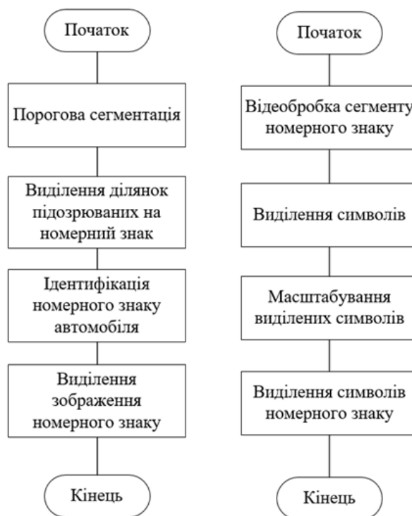
Рисунок 1.6 – Основні етапи процесу виділення зображення номерного знаку автомашини
