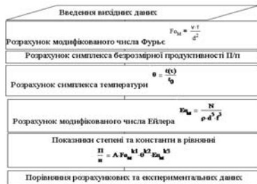
Рис. 38. Алгоритм узагальнення експериментальних даних при зміні напруженості магнітного поля
