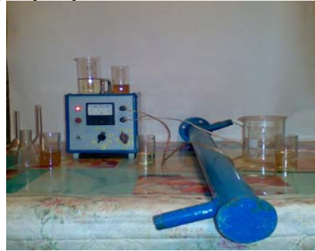
Рис. 51 Пілотно установка електромагнітної обробки рослинних олій
