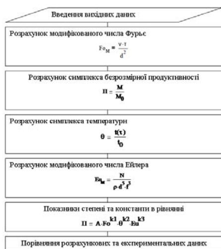
Рис. 32. Алгоритм узагальнення експериментальних даних при фільтрації в умовах ультразвукової кавітації.
