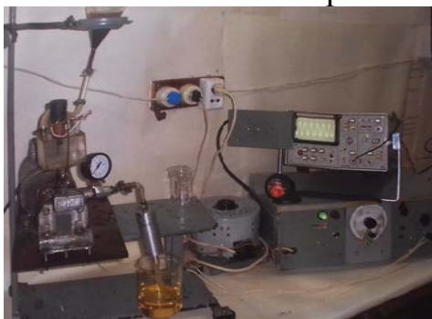
Рис. 50. Пілотна установка ультразвукової обробки рослинних олій при первинній очистці.
