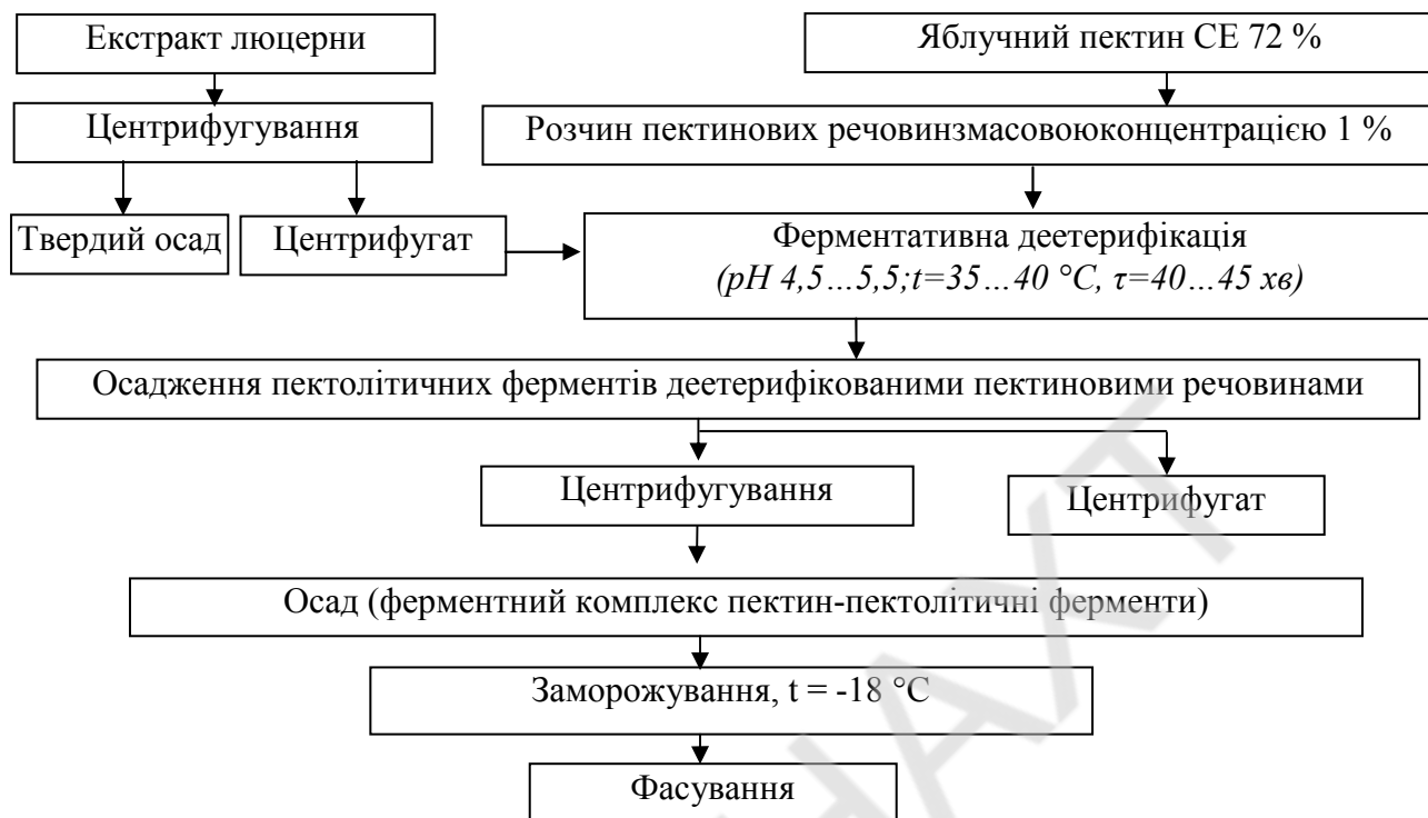
Рис. 1 — Принципова схема отримання композиційних пектолітичних ферментів з ПМЕ активністю
