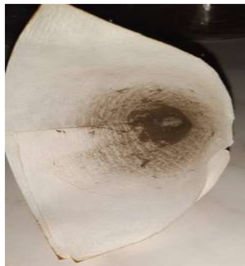
Рисунок 1.15 – Висушений осад відфільтрованої дощової води
