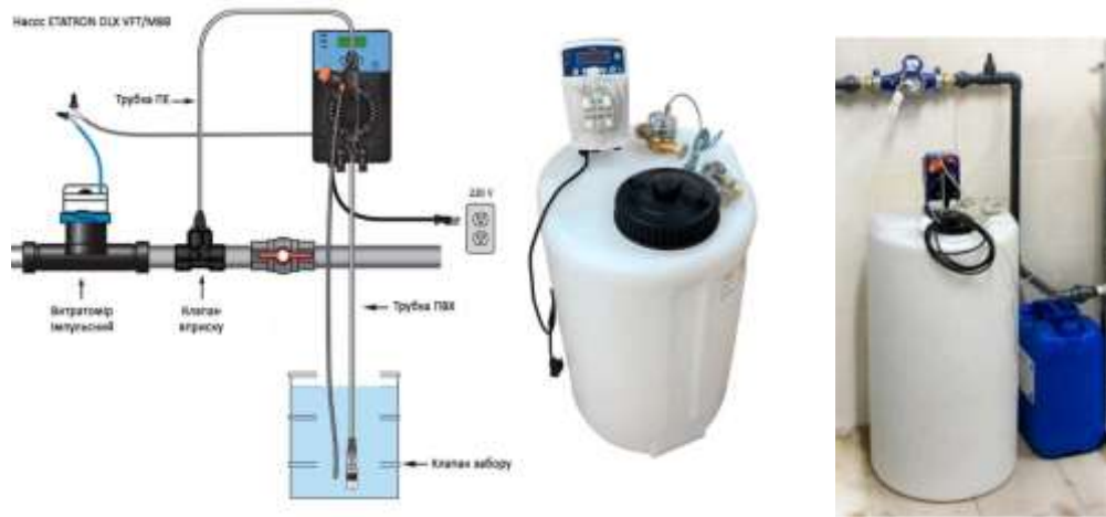
Рисунок 3.9 – Конструктивні елементи та зовнішній вигляд станції для приготування і дозування гіпохлориту натрію у воду [66, 67]
