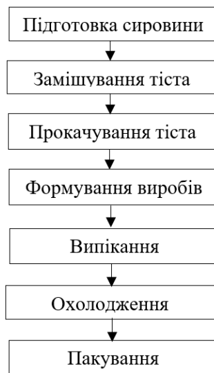
Рисунок 2.8 Узагальнена технологічна схема виробництва печива.
