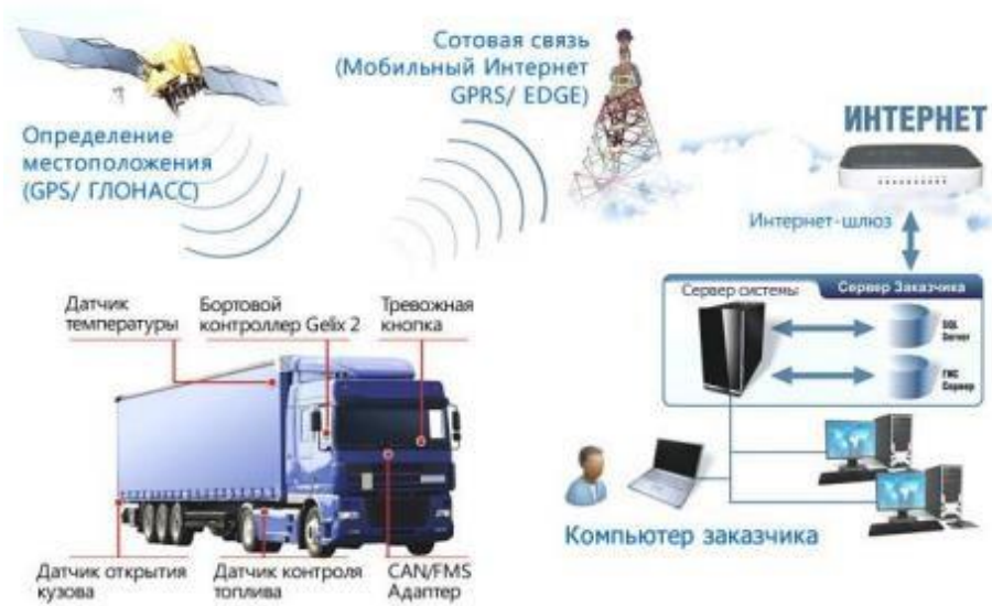
Рис. Б.1. Схематичне зображення роботи GPS-трекера
