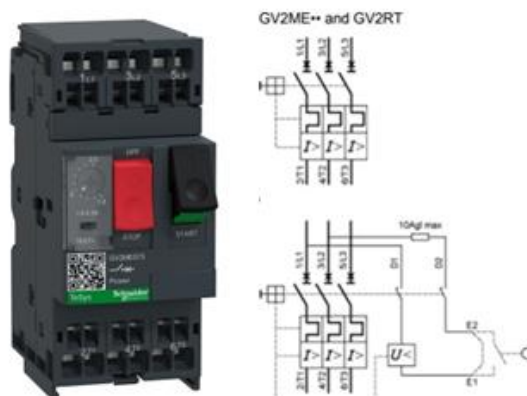
Рисунок 5.16 – Зовнішній вигляд та схема підключення автоматичного вимикача Schneider GV2ME143
