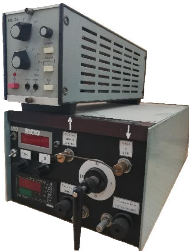
Рисунок 30 – Аналітичний комплекс формування, перетворення та посилення електричного сигналу детектора: Прилад зверху – БІД-36; Прилад знизу - "Компаратор"
