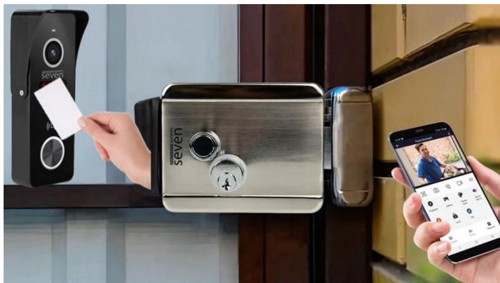
Рисунок 1.12. Система контролю доступу з електромеханічним замком на основі RFID карток та Wi-Fi
