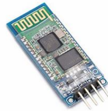
Bluetooth модуль HC-06 для реалізації СКД
