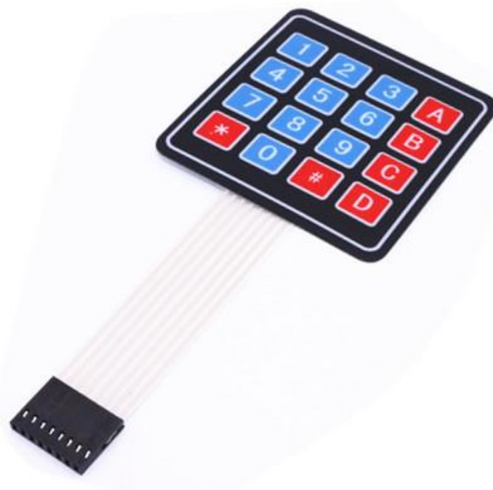
Рисунок 1.21. Зовнішній вид матричної клавіатури
