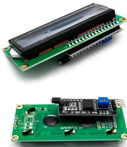
Рисунок 1.14. Дисплей LCD 1602A з вбудованим контролером
