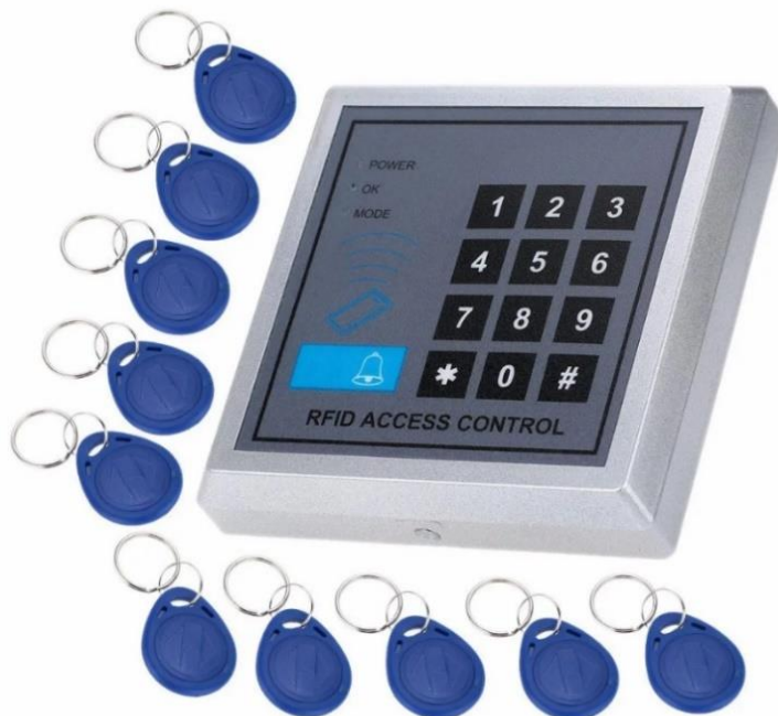
Рисунок 1.1. Серійний термінал допуску з RFID мітками
