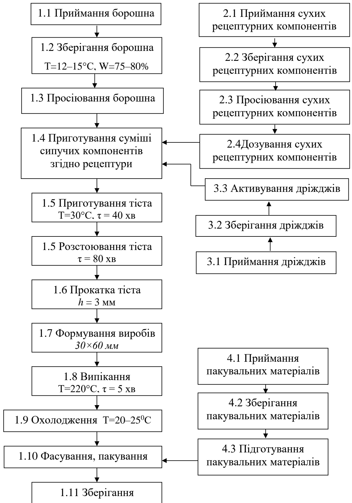
Рис. 4.1. Технологічна схема виробництва галет
