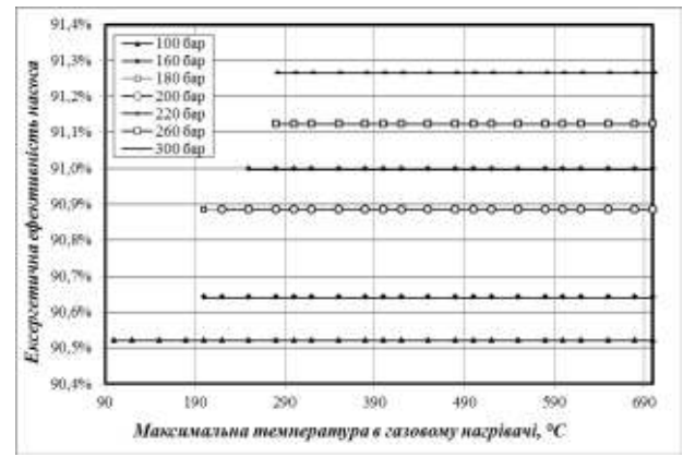
Рис. 4.31. Залежність ексергетичної ефективності насоса \eta_{ен} від тиску p_{гн} та максимальної температури t_{гн} в газовому нагрівачі:
