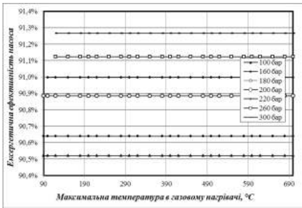
Рис. 4.31. Залежність ексергетичної ефективності насоса \eta_{ен} від тиску p_{гн} та максимальної температури t_{гн} в газовому нагрівачі:
