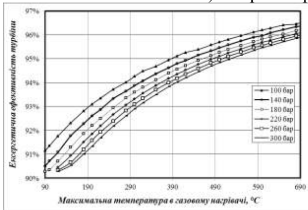
Рис. 4.32. Залежність ексергетичної ефективності турбіни \eta_{ем} від тиску p_{гн} та максимальної температури t_{гн} в газовому нагрівачі:
