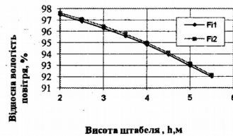
Рис. 6. Графік залежності оптимальних значень відносної вологості повітря на вході до штабеля яблук ( F_1 ) та моркви ( F_2 )
