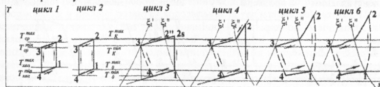
Рис.2. «Метод циклів» для аналізу КУ на неазеотропній суміші.
