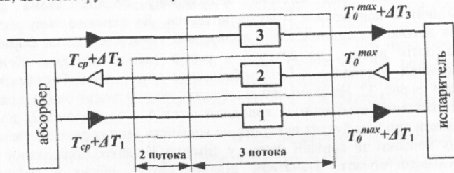
Рис. 34. Принципова схема трипотокового теплообмінника.
