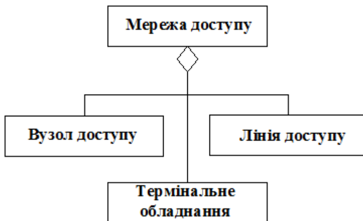
Рис. 2.9 – Відношення агрегації на прикладі МД
