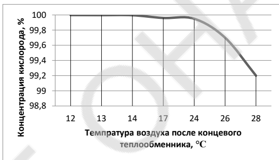
Рис. 2. График зависимость концентрации получаемого кислорода от температуры воздуха после конечного холодильника.
