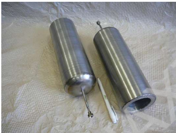
Рис. 3 – Робочі дільниці прецизійних «нуль»-термостатів, розроблених в ІПМ ім.І.М. Францевича, у стані поставки
