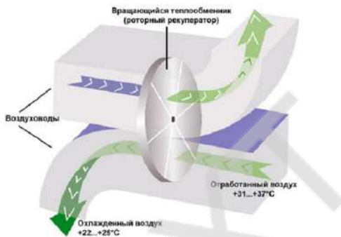
Рис 2 - Роторный рекуператор
