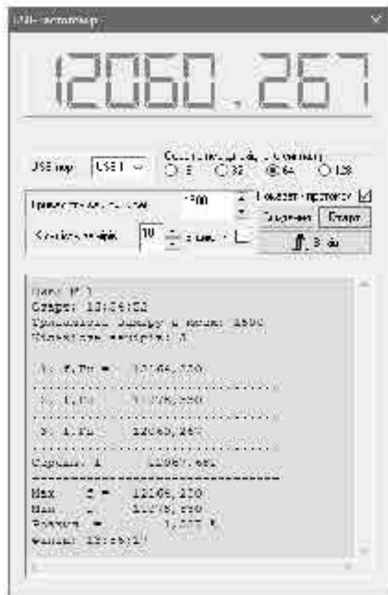
Рисунок 4.10. Зовнішній вигляд вікна програми USB-частотоміру з протоколом і результатами вимірювань
