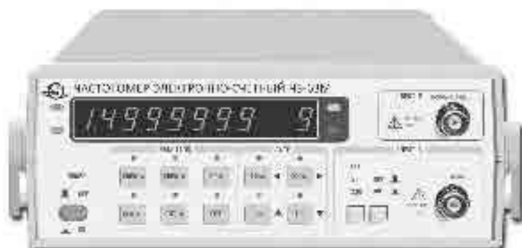
Рисунок 1.1. Зовнішній вигляд електронно-рахункового частотоміру
